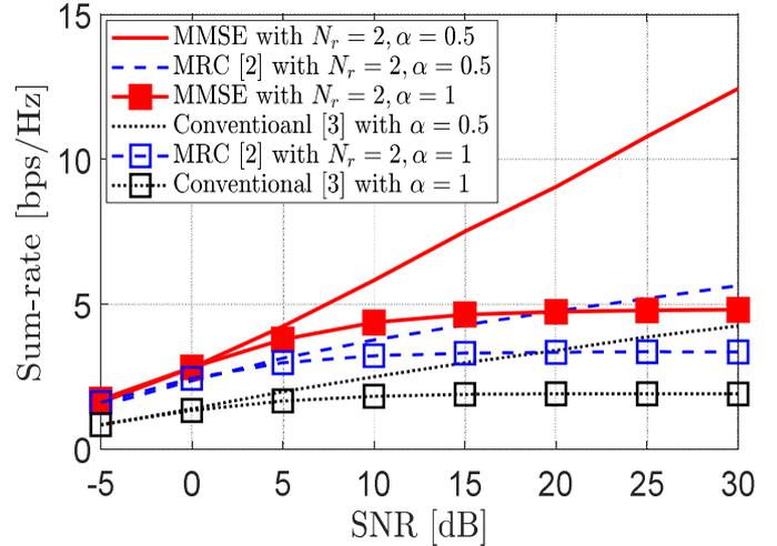
그림 1은 송/수신기 쌍이 4개인 경우, 단일안테나 수신기를 고려하였을 때 [3]와 다중안테나를 이용한 MRC [2]와 MMSE기반의 수신 빔포밍 기술을 적용하였을 때, 전체 네트워크에서 달성 가능한 전송률 (achievable sum-rate)을 보여준다. [3]은 단일안테나 수신기를 고려했기 때문에 수신 빔포밍을 적용한 경우보다 전송률이 낮다. 또한, MRC기반 수신 빔포밍 기술 [2]은 원하는 채널 이득을 극대화하므로 간섭채널 이득은 고려되지 않기 때문에, 간섭채널 이득까지 고려하는 MMSE기반 수신 빔포밍 기술의 전송률이 월등히 높은 것을 확인할 수 있다.
